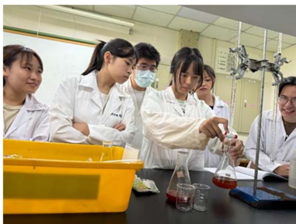
▲油脂中之過氧化物，由碘滴定法來測定其含量
